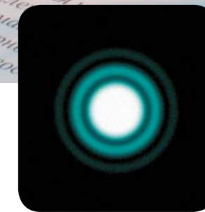
Фотография лазерного пятна, сфокусированного дифракционной линзой с числовой апертурой NA=0,65
