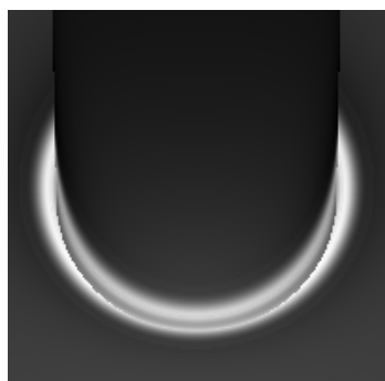
Рис. 2.52. Изображения мениска при R=5 и различных углах роста кристалла \beta ( N_D=1 )
