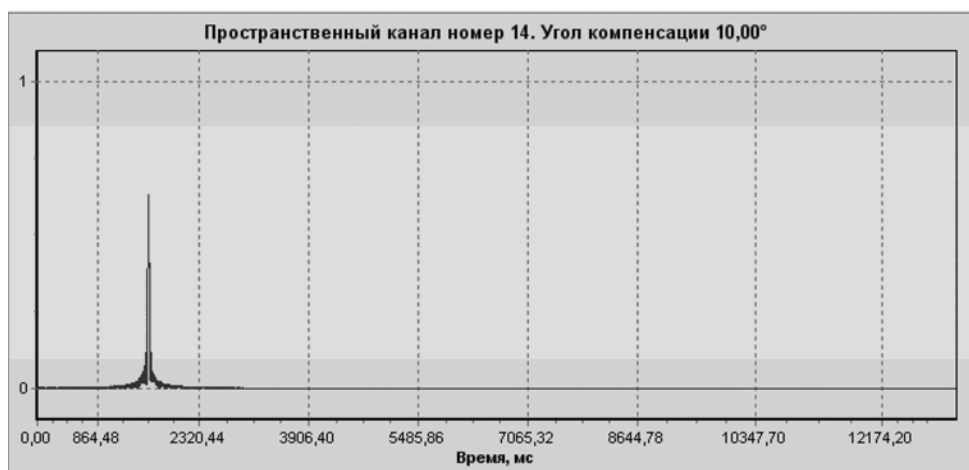
Рис. 2.38. Модуль комплексной огибающей сигнала после согласованной фильтрации в пространственном канале
