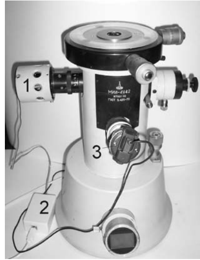
Рис. 2.7. Модернизированный микроинтерферометр МИИ-4
