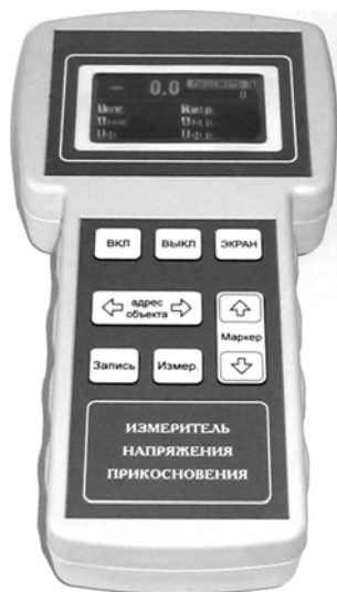
Рис. 6.6. Измеритель напряжения прикосновения (ИНП)
