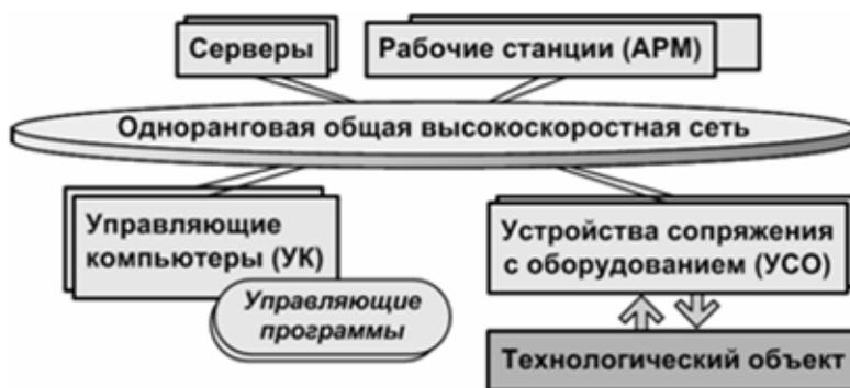
**Рис. 2.45.** Организация системы автоматизации с одноранговой архитектурой
