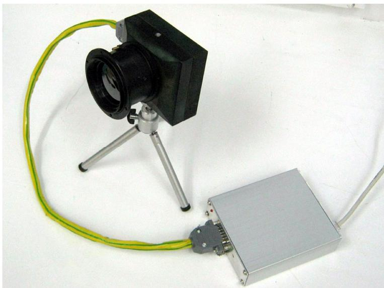
**Рис. 6.4.** Фотоприемное устройство ИК-диапазона
