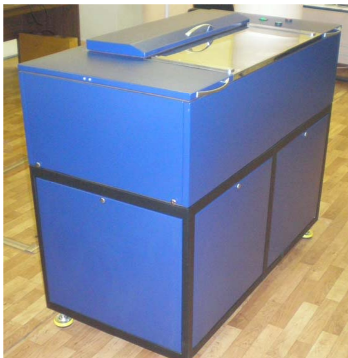
Лазерный фотопостроитель (ЛФ) для изготовления большеформатных фотошаблонов на фототехнической пленке «Ромб-VIS-ФШ»
